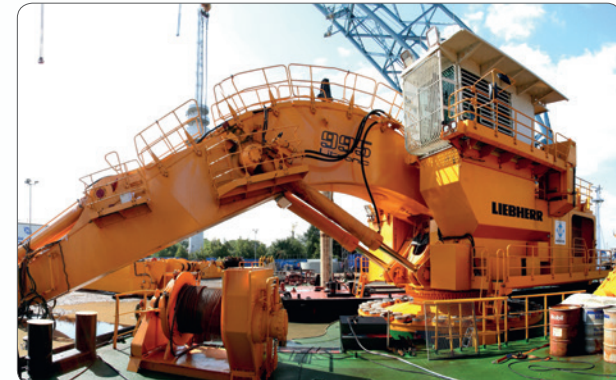
Escavatore di pontoni Liebherr P 995 Litronic - in uso durante la costruzione del porto per containers a Wilhelmshaven.
